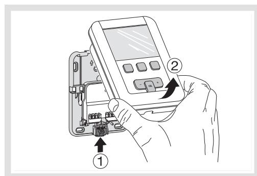
2. Open de klep met een schroevendraaier en bevestig de wandmontageplaat met de schroeven.
