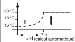
**Anticipatie**: met deze functie wordt de Comfort **2<sup>e</sup>** of Comfort 2 **2<sup>e</sup>** - temperatuur van het eigen gemaakte programma (**P4**), vervroegd toegepast, voor een instelbare tijdsduur van 1, 2 of 3 uur.
