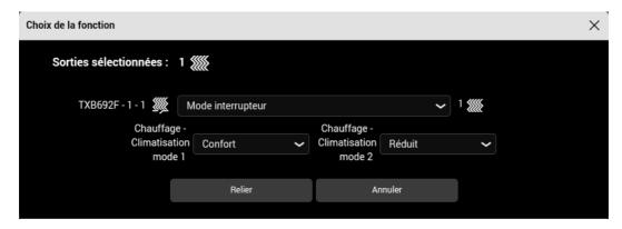
Mode de chauffage disponible : Auto, Confort, Standby, Réduit et Protection gel.
