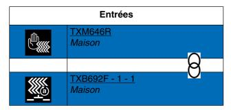
La fermeture du contact de l'entrée provoque l'activation du mode de chauffage 1. L'ouverture du contact de l'entrée provoque l'activation du mode de chauffage 2. L'effet de la commande est annulé par toute autre commande d'activation de mode.
